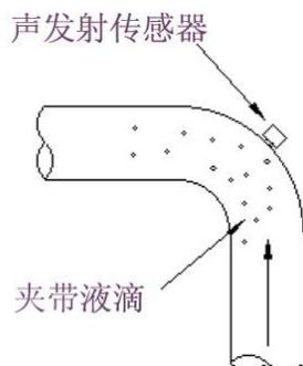
由于管路中的高温(185°C),弯管外面焊接了一个316不锈钢波导管。这样就形成了温差,防止传感器暴露在高于115°C(传感器最高运行温度)的环境中。由于颗粒夹带产生的声发射信号很强,波导管引起的衰减对于测量灵敏度的影响缩减为最小程度。
