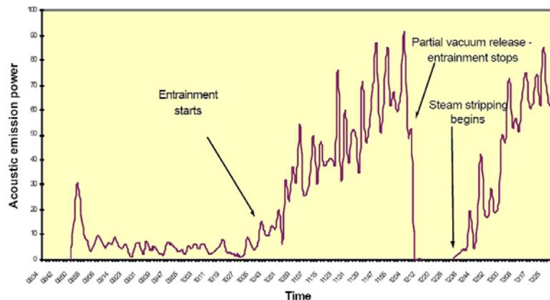
对分批生产过程进行声发射监测,很清晰的看到颗粒夹带的开始。通过声发射的监控,可使生产过程中不必要的产品夹带减至最少。
